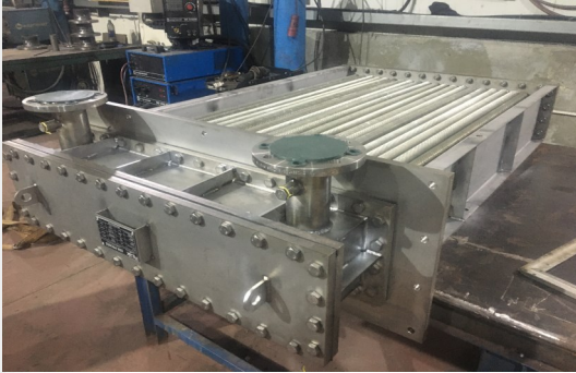
ÇELİKLER SEYİTÖMER SANTRALİ Pompa Motor Soğutucu Radyatörleri
