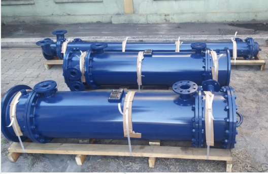
ADAPAZARI ŞEKER FAB. Türbin Yağ Soğutucu Eşanjörleri
